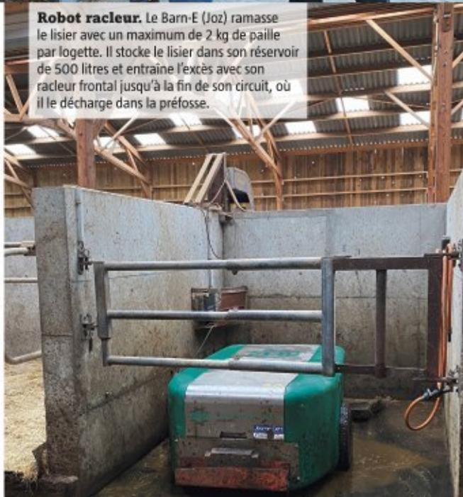
Robot racleur. Le Barn-E (Joz) ramasse le lisier avec un maximum de 2 kg de paille par logette. Il stocke le lisier dans son réservoir de 500 litres et entraîne l'excès avec son racleur frontal jusqu'à la fin de son circuit, où il le décharge dans la préfosse.
